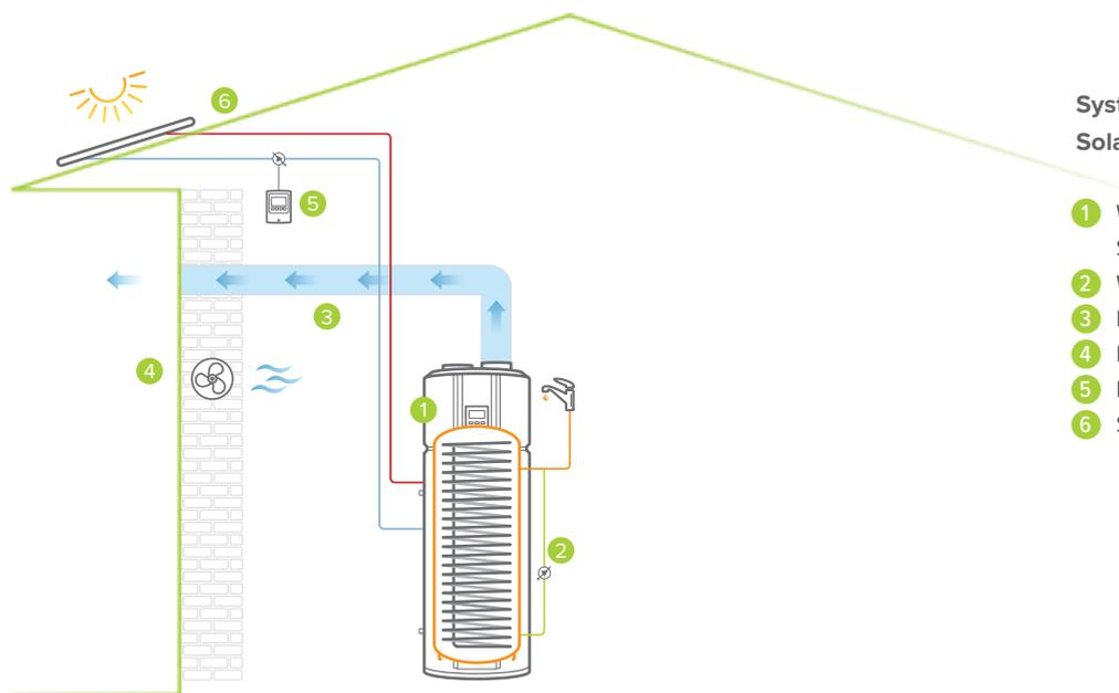
System zur Warmwasserbereitung mit Solarthermie:
